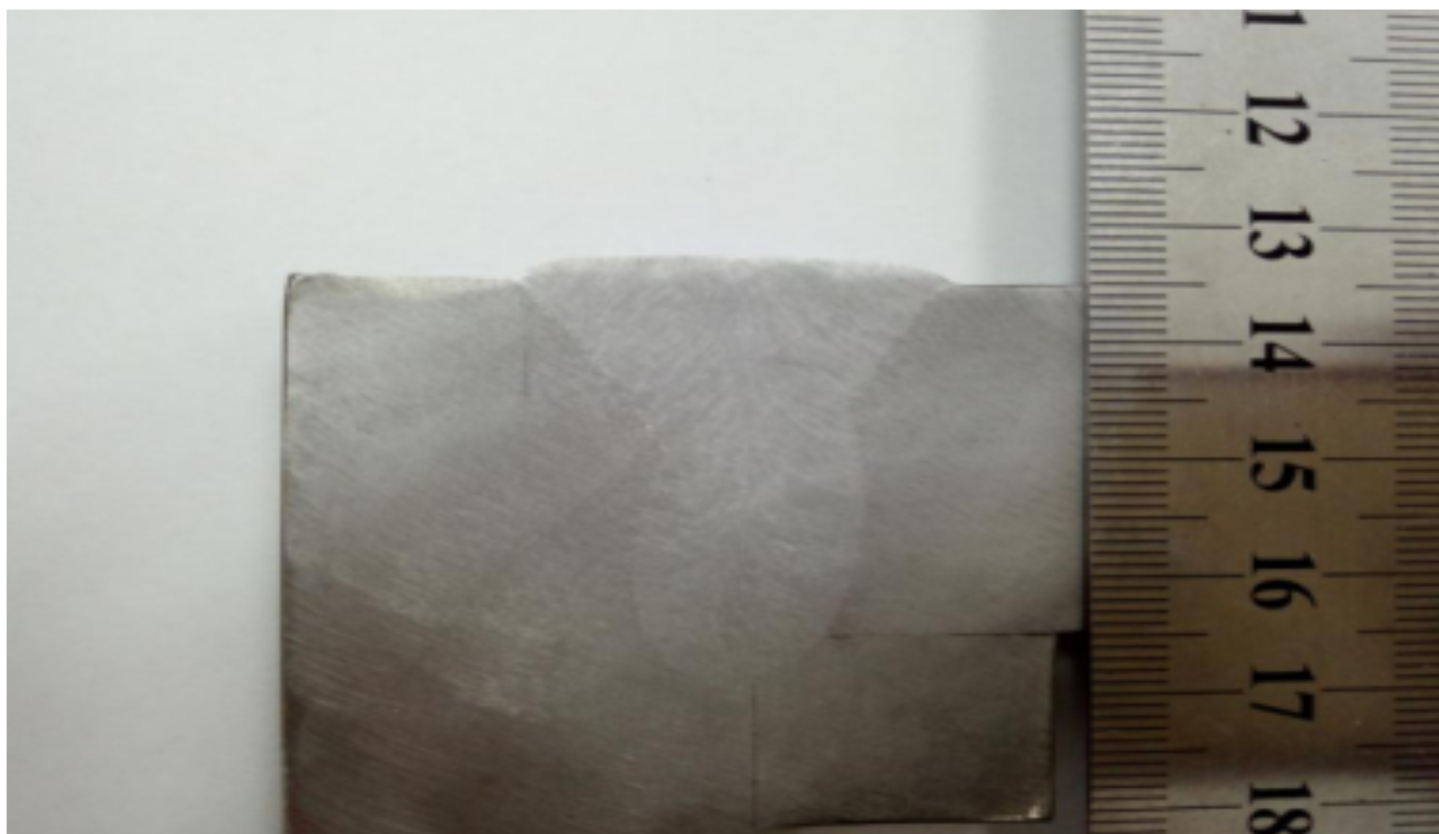
▲ 30mm板厚接头宏观照片
